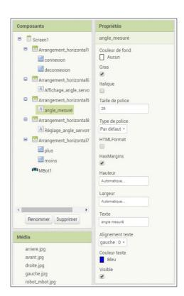
Et le programme...attention, il faut initialiser l'angle du servomoteur au départ (ici 90 °) puis on modifie l'angle de 5° en 5°, on affiche sur l'écran et on commande le servomoteur avec cette valeur.
