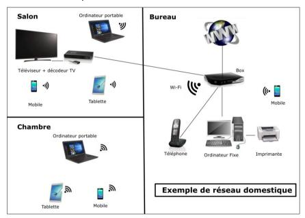
Ce réseau permet de connecter ordinateurs, tablettes, smartphones, imprimantes,... à une box. La box permet de raccorder les équipements informatiques de la maison à Internet. Elle nous permet de paramétrer les réglages du réseau (Wi-Fi, contrôle parental...), mais aussi de stocker des données (rôle de disque dur).
