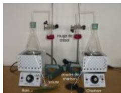
mise en évidence du dégagement de CO 2 par le rouge de crésol
