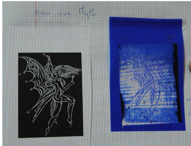
Image d'origine en négatif et reste de la feuille mylar après transfert sur la plaque de métal
