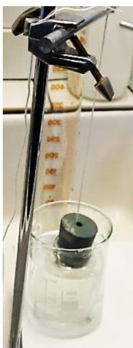
Figure 23 : Flacon cylindrique rempli d'eau et fermé par un bouchon, suspendu par une potence et plongeant dans un bécber rempli d'eau avec des bulles
