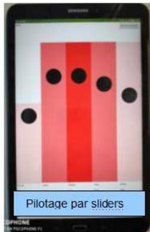
L'application produite se veut simple mais affordante. Elle permet de piloter chaque doigt de la main, par l'intermédiaire de boutons mais également à l'aide de sliders permettant un pilotage plus "tactile".
