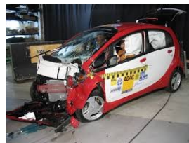
Crash test réel d'un véhicule réel, vérification des données calculées.
