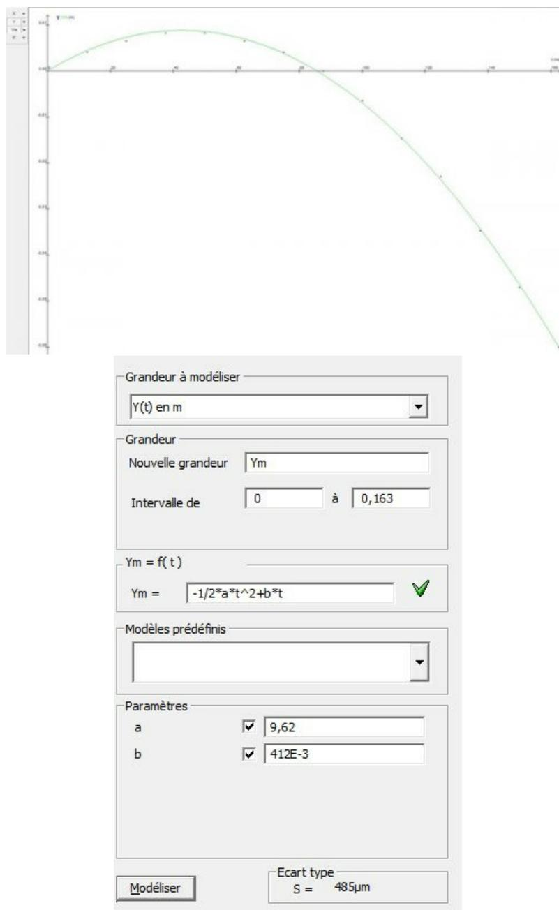
Ces résultats sont en accord avec les mesures de vitesse faites en sortie de rail avec le module RAPIDO-Lasers qui
