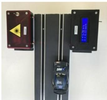
Le module PARABOLE peut également être équipé du module [RAPIDO-Lasers](#) qui permet de mesurer la vitesse en sortie de rail.
