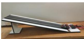
Le module PARABOLE permet l'étude de la chute parabolique d'une voiture (miniature).
