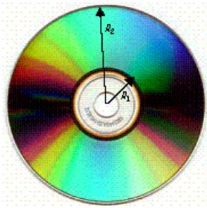
Lorsque la face d'un CD ou d'un DVD est présentée à la lumière blanche, la lumière réfléchiée est irisée, donc décomposée. Le disque se comporte alors comme un réseau optique en réflexion. Si celui-ci est éclairé par un faisceau laser — monochromatique —, la lumière est alors réfléchiée dans des directions bien déterminées.
