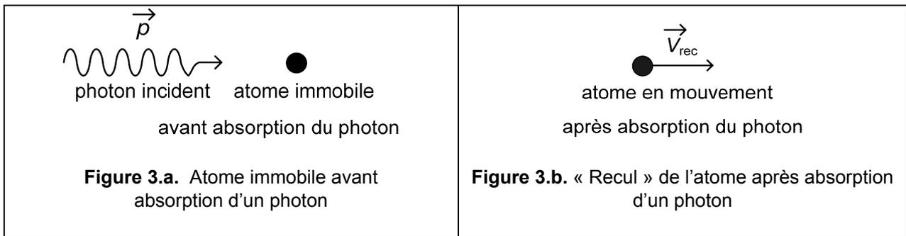
Dans la situation décrite par les figures 3.a et 3.b, montrer que la valeur de la vitesse de « recul »  $V_{\text{rec}}$  dans le référentiel du laboratoire, a pour expression :  $V_{\text{rec}} = \frac{h}{\lambda M}$  avec  $h$  la constante de Planck,  $\lambda$  la longueur d'onde du laser, et  $M$  la masse de l'atome de césium. Calculer la valeur de la vitesse  $V_{\text{rec}}$ .
