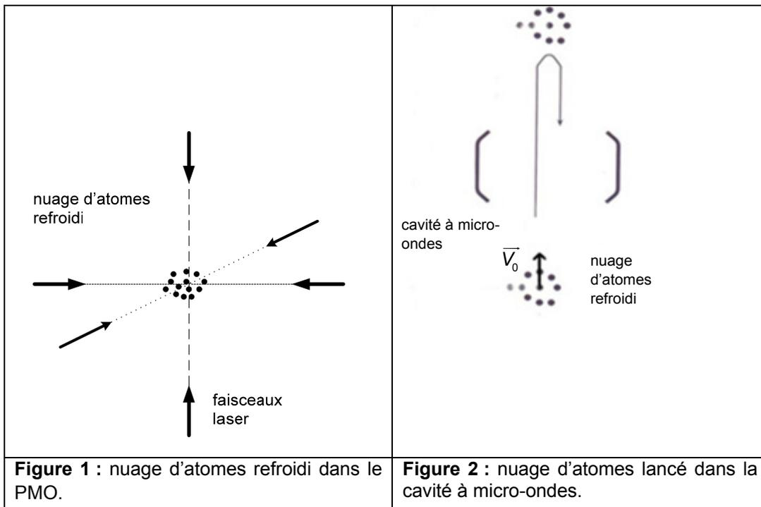
La précision de ce type d'horloge est d'autant plus grande que le temps séparant les deux passages par la cavité à micro-ondes est grand.
