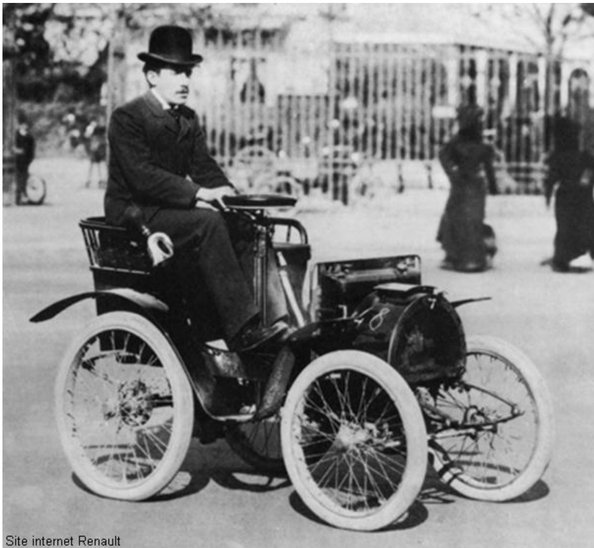
Louis Renault au volant de la Type A, première « voiturette » avec une transmission en prise directe sur le moteur, mise au point par les frères Renault le 24 décembre 1898
