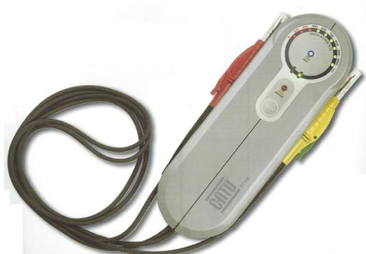
Les cordons de mesure : les parties conductrices des pointes de touches doivent lorsqu'elles ne sont pas utilisées, **avoir un indice de protection IP 2X**.
