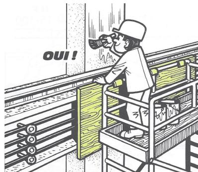
L'interposition d'obstacle consiste également en l'utilisation **d'enveloppes** (boîtiers, coffrets, armoires, etc.) permettant de protéger les personnes contre les contacts directs.
