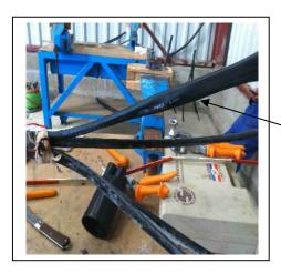
Rétractation de la GRN a l'aide d'un chalumeau. Attention a ne pas bruler la GRN au risque quelle perdent ses qualités d'étanchéité et d'isolation. Chauffez du bas vers le haut
