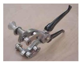
> Une pince Pintel4-BT permettant le dégainage de la gaine plomb du neutre
