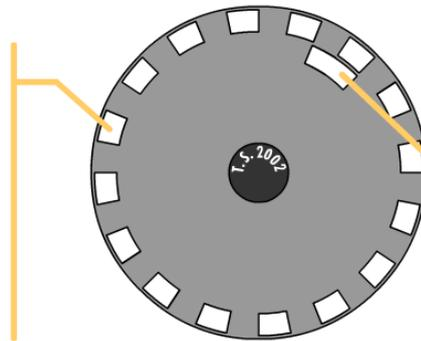
**Piste intérieure (Z: top zéro)**, qui ne comporte qu'une seule fenêtre et qui délivre qu'un signal par tour du disque. Ce « top zéro » permet de réinitialiser la partie commande et de connaître une position d'origine.
