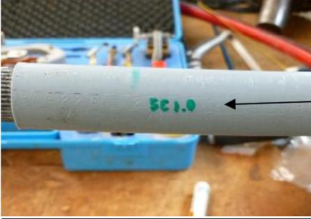
Pour enlever le semi-conducteur pelable, il faut régler le stylet de l'outil en fonction de l'épaisseur du semi-conducteur indiqué sur le câble.
