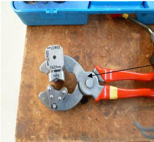
Outil permettant de créer les fentes pour la mise en place de la prise d'écran
