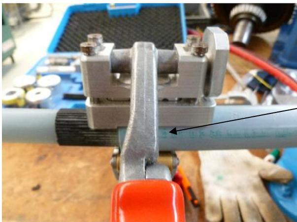
Positionner l'outil et serrer pour créer la fente. Attention, ne pas créer de fente sur la surépaisseur du feuillard, pour cela, ne pas faire de fente sur la ligne ou sont indiquer les références du câble.
