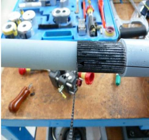
Lorsque vous arrivez a la fin, retirer la dernière bande de semi-conducteur doucement (risque de rupture) pour pouvoir avoir une coupe net et droite du semi-conducteur restant sur le câble.
