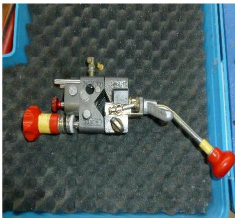
Utilisation de l'outil multifonction pour le dégainage du feuillard et de la gaine extérieure
