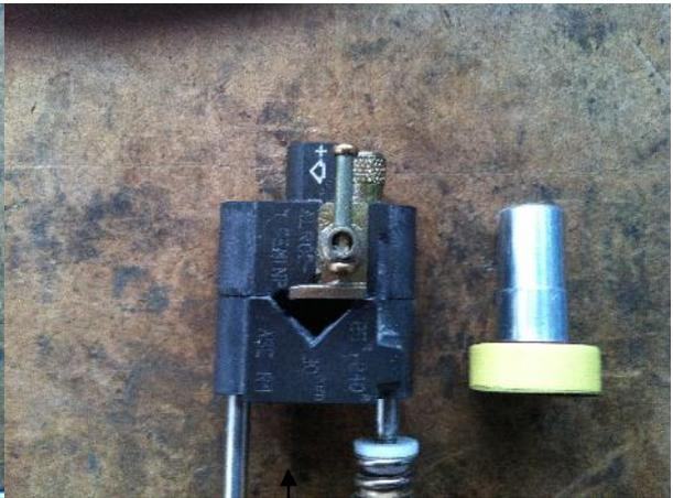
Régler l'outil permettant de retirer le semi-conducteur non-pelable a l'aide du gabarit fourni.
