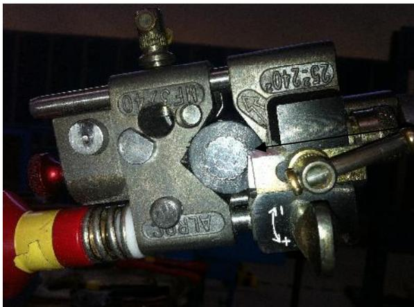
Réglage de l'outil pour le retrait de l'isolant et du semi-conducteur interne.
