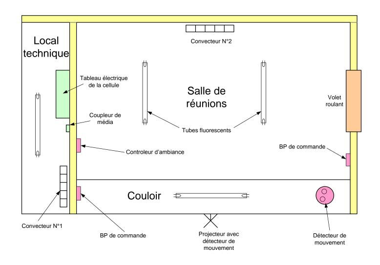
Cellule 3D avec BUS de communication « KNX »
