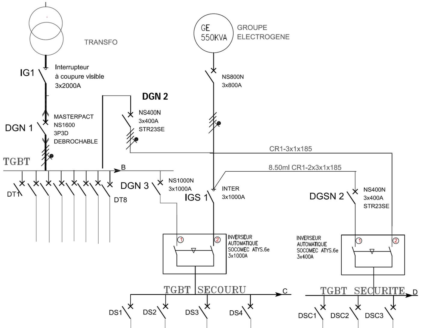
C.2 Identifier le type de commutation utilisée par les deux inverseurs de source sachant que le démarrage du groupe électrogène intervient lors de la disparition du réseau EDF. Justifier votre réponse.
