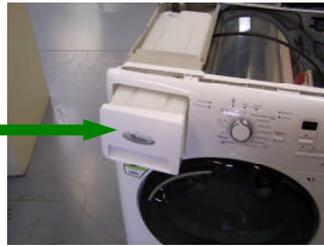
14. Dévisser la vis cachée derrière le bac avec le tournevis torx de 20.
