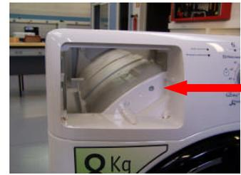
15. Agir délicatement avec un gros tournevis plat à gauche puis à droite et enfin à la base intérieure du bandeau afin de le décliper.
