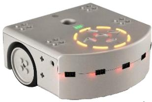
Comparé aux premiers ordinateurs, le petit robot Thymio est un véritable génie. Truffé de capteurs qui lui permettent de réagir à son environnement (capteurs infrarouges, boutons de commande, microphone, ...), il est capable d'exécuter des programmes écrits dans un langage clair et compréhensible par tous.
