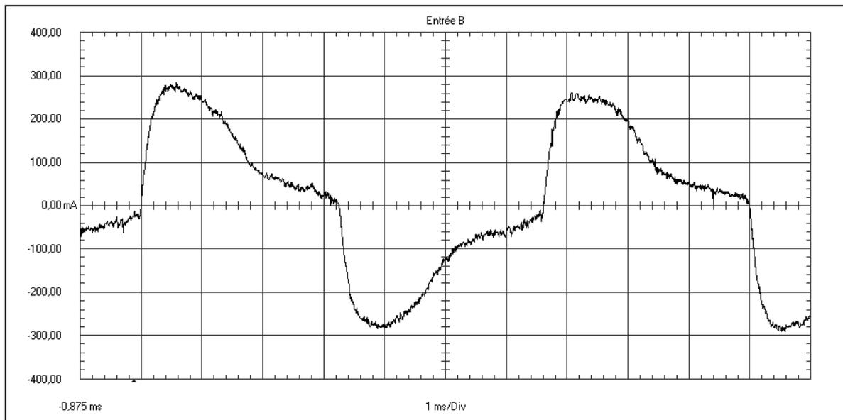
Calculer la fréquence du courant dans le neutre.
