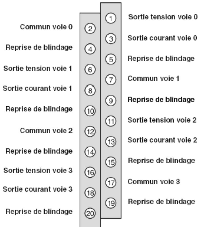
**NOTA :** Il est recommandé d'utiliser des câbles blindés et de relier le blindage aux bornes prévues à cet effet (reprise de blindage)
